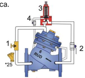
Esta Válvula lleva montadas, además, dos válvulas de esfera (2,4) que facilitan su operación y mantenimiento.
